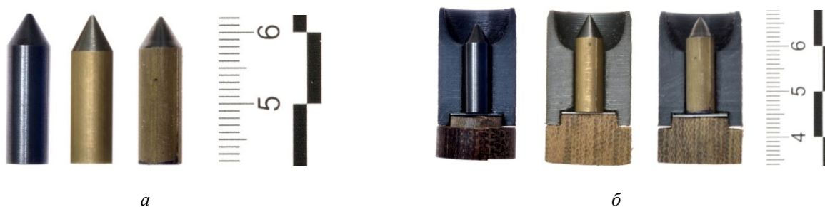
Рис. 1. Внешний вид ударников (а); ударники в ведущем устройстве (б)
